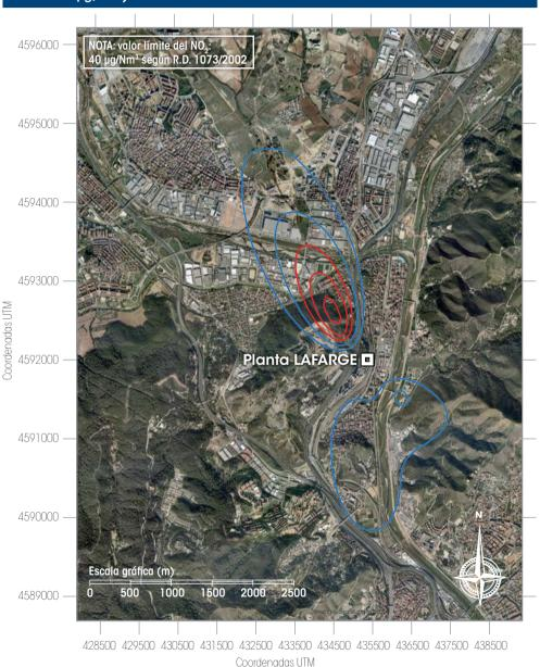
Figura A.6. Dispersión de la emisión de  $SO_2$  para valores límite de emisión (valores en  $\mu g/Nm^3$ ).
