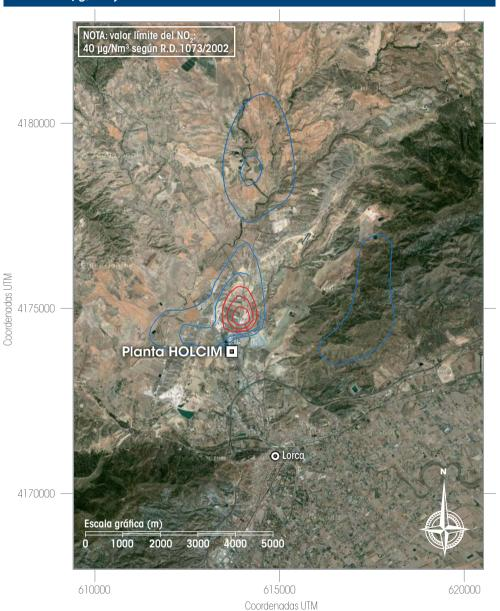
Figura A.3. Dispersión de la emisión de  $SO_2$  para valores límite de emisión (valores en  $\mu g/Nm^3$ ).
