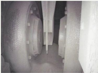
Figura 3.13. Molino vertical de rodillos
