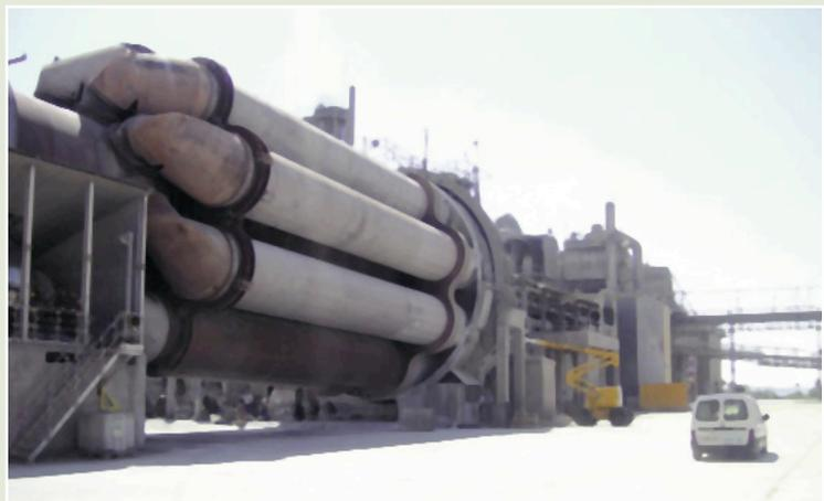
para el volteo y dispersión del clinker son esenciales. Este tipo de enfriador no presenta ningún parámetro operativo variable. El alto desgaste y el choque térmico, en conjunción con los ciclos de polvo dentro de los tubos, origina que el clinker salga con altas temperaturas por lo que el ratio de recuperación de calor es bajo. La temperatura de salida del clinker sólo puede reducirse por inyección de agua dentro de los tubos del enfriador o sobre la carcasa de los mismos.
