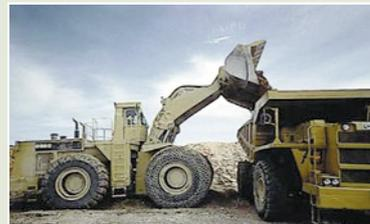
Figura 3.2. Carga de caliza
