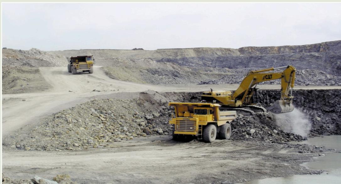
Retroexcavadora cargando material en dumper
