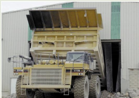
Figura 13. 5. Descarga en tolva de alimentación
