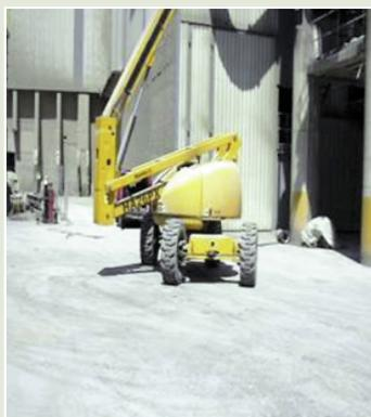
Figura 14. 2. Desplazamiento indebido de la plataforma
