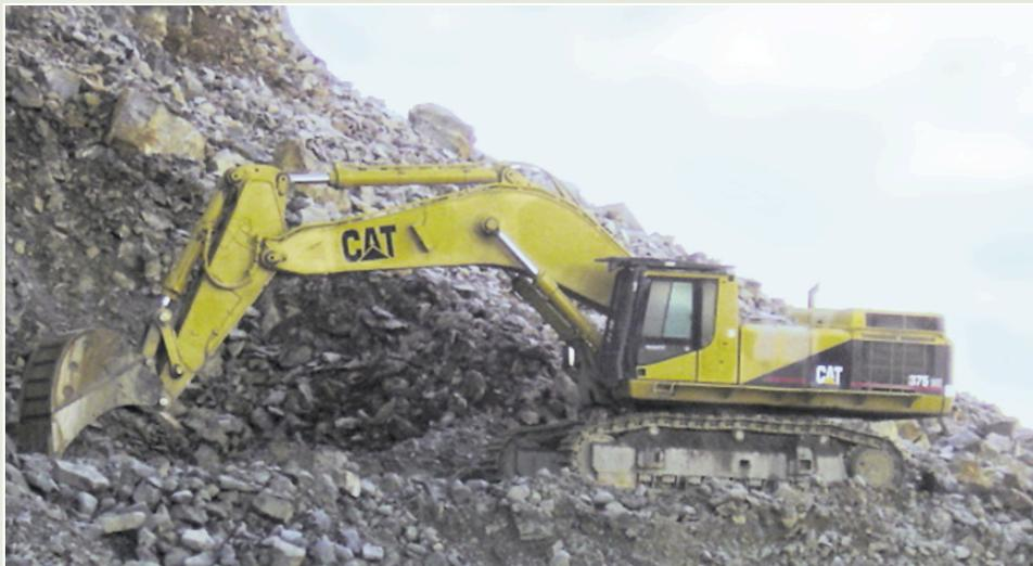
Figura 13. 1. Carga de material previamente volado
