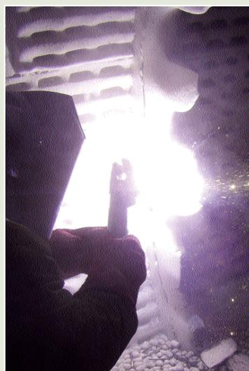
Figura 19. 5. Reparación del molino
