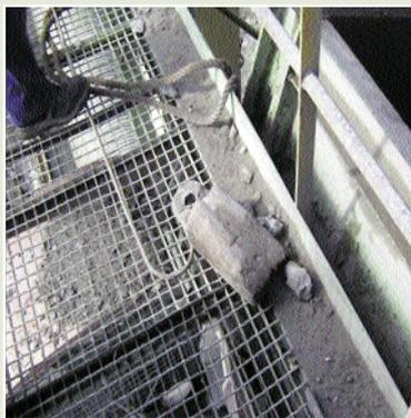
Figura 20. 6. Pieza metálica empleada para el desatascado
