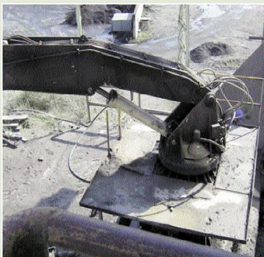
Figura 20. 3. Machacadora con medios mecánicos
