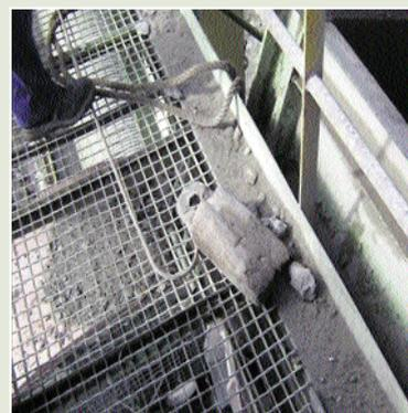
Pieza metálica empleada para el desatasco
